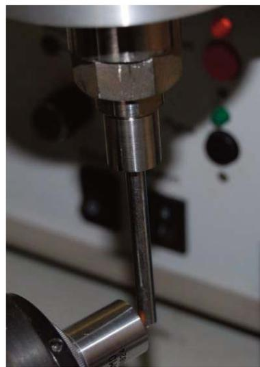
Рис. 1, 2. Измерение амплитуды колебаний с помощью микроскопа микротвердомера МТВ-1У4.2
