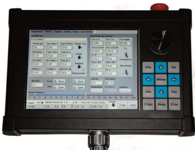
Рис. 3. Внешний вид панели оператора аппаратуры Гелиос с интерфейсом программы задания параметров режима сварки
