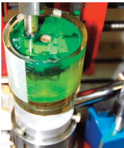
Рис. 7. Наложение УЗК на обрабатываемую деталь
