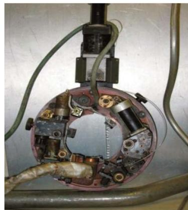
Рис. 1. Головки для сварки НСТ типа ГНС разработки 70-80-х гг. XX века
