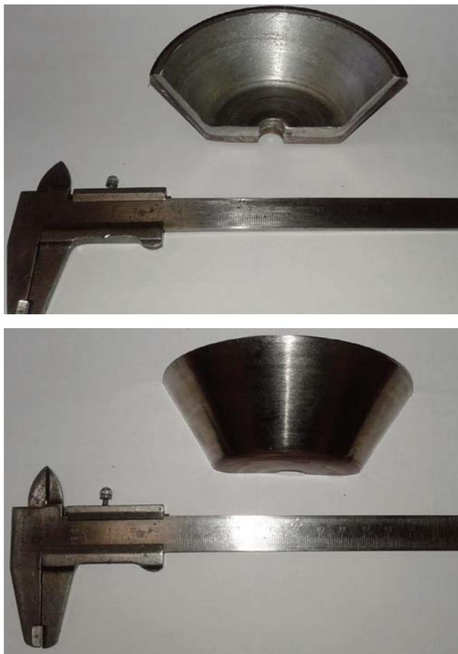
Рис. 3. Заготовка после операции РВ с учетом переутонения
