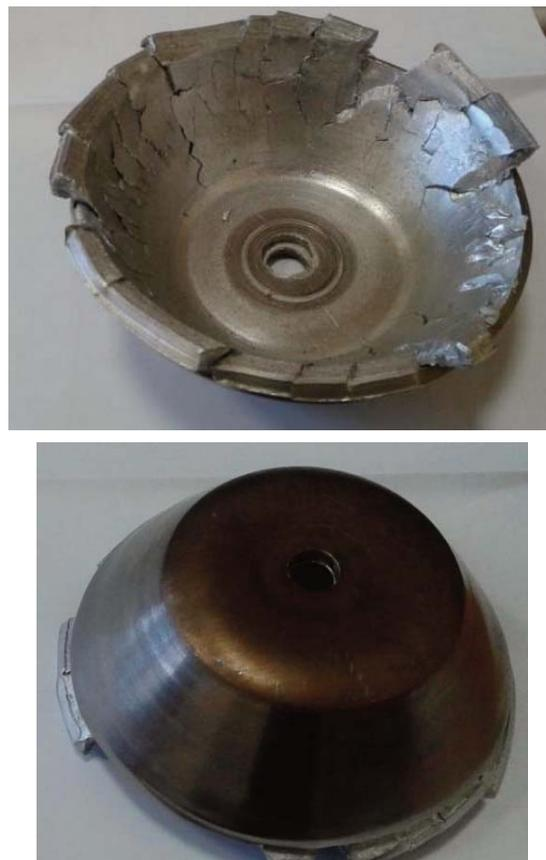
Рис. 2. Заготовка после операции ротационной вытяжки согласно рекомендаций [3]
