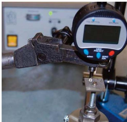
Рис. 3, 4. Измерение амплитуды колебаний с помощью электронно-цифрового индикатора Vogel
